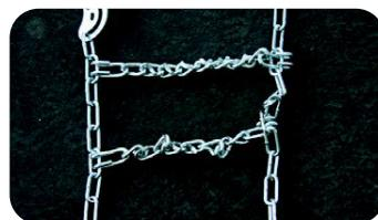
Si las cadenas GORILA® corresponden al modelo con púas rompehielos, las púas deben quedar en contacto con el camino, nunca hacia el neumático.
